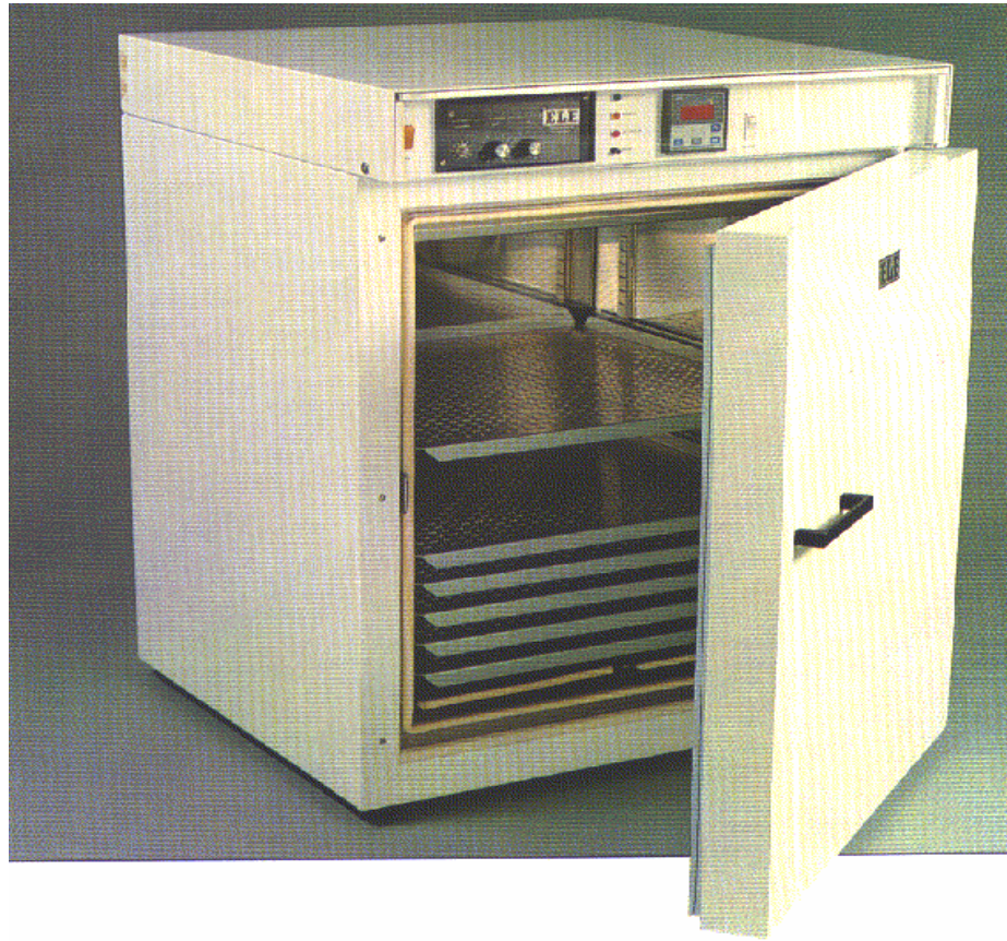
Figura 1.1. Horno de secado de temperatura regulable. Fuente: ELE Internacional Ltda., 1993.
